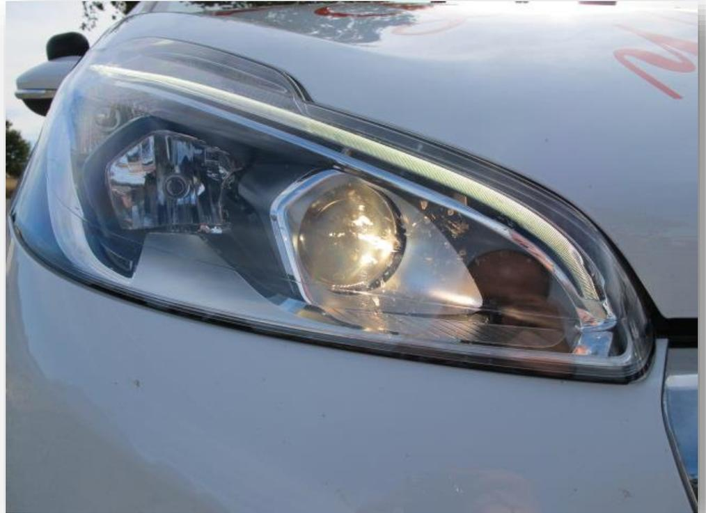
*Diminution de l'éclairage et risque d'être confondu avec un véhicule deux-roues*
