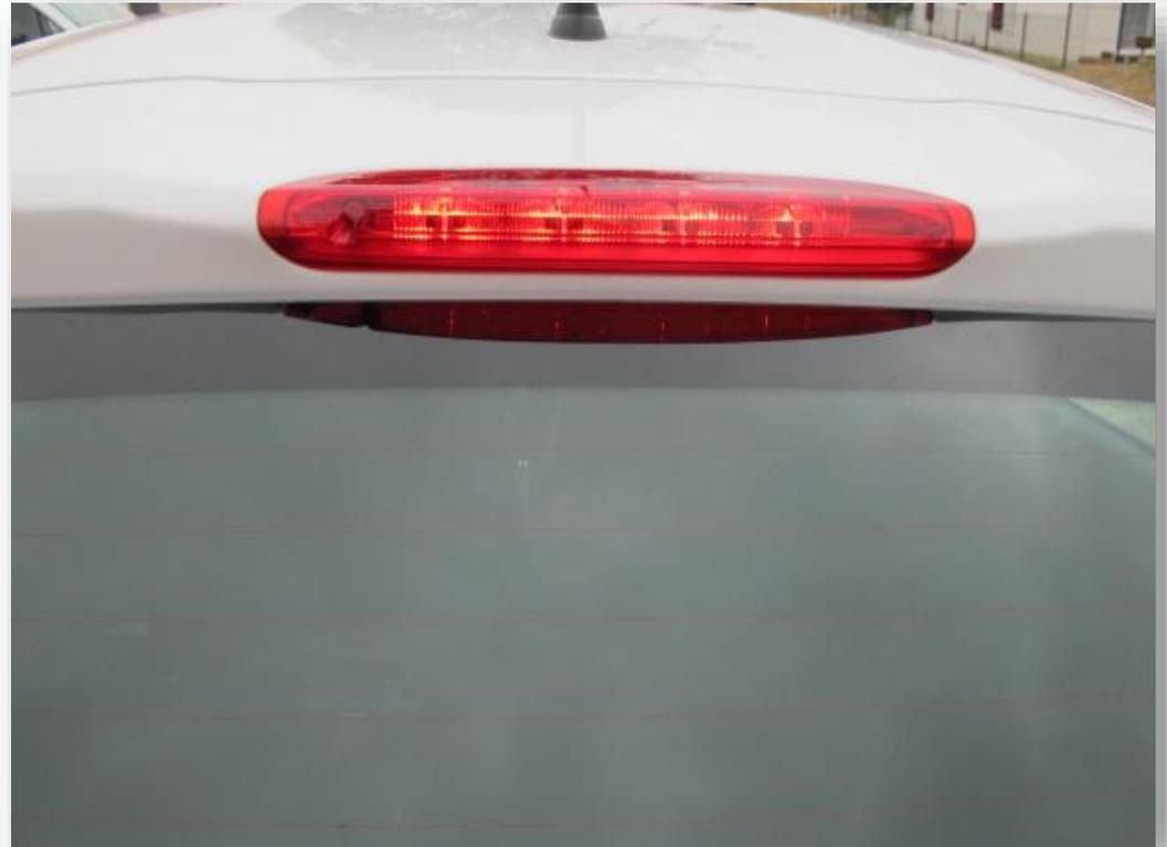
*Avertir le véhicule derrière d'un ralentissement ou d'un arrêt*
