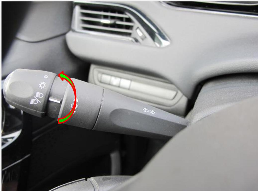
*Faites pivoter vers l'avant, l'embout de la commande des feux, de 2 crans*
