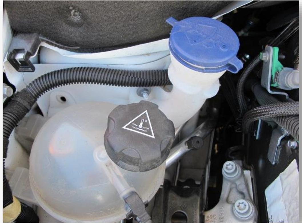
*Risque de brûlure car liquide chaud sous pression*
