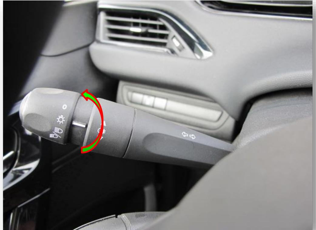
*Faites pivoter vers l'avant, l'embout de la commande des feux, d'un cran*
